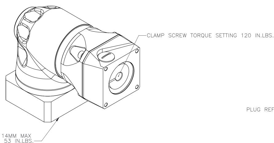
MOTOR INPUT SHAFT DIAMETER 14MM MAX CLAMP SCREW TORQUE SETTING 53 IN.LBS.
